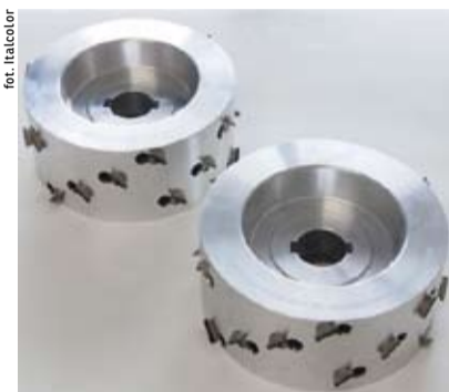
Wymienne nożyki stwarzają możliwość ich zamiany lub wymiany.
